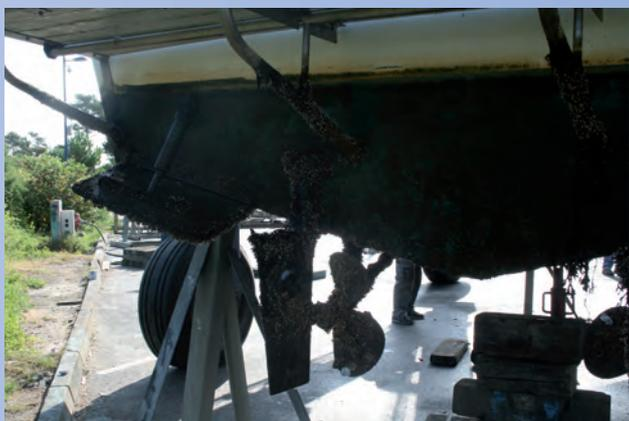
Le Barracuda III a été sorti d'eau les 8-9 et 10 août pour le carénage annuel. Les anodes ont pu être changées et les injecteurs démontés pour nettoyage et tarage. Nos adhérents et salariées se sont attelés au nettoyage de la coque, des hélices, des safrans et des flaps.
