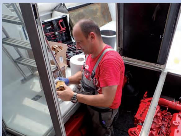
Le 23 août, notre mécanicien a effectué un nettoyage des filtres et pré-filtres, et a traité le gasoil avec un produit curatif.
