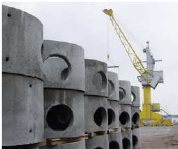
Photo 1 : buses en béton (d'après ALR)
