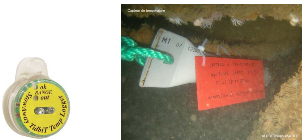
Figure 6 : capteur de température (à gauche) et in situ (à droite, d'après ALR)
