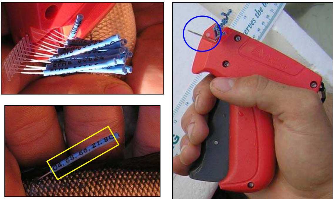
Figure 13 : Spaghetti de type T-bar anchor tag et son pistolet injecteur (d'après EPHE).
