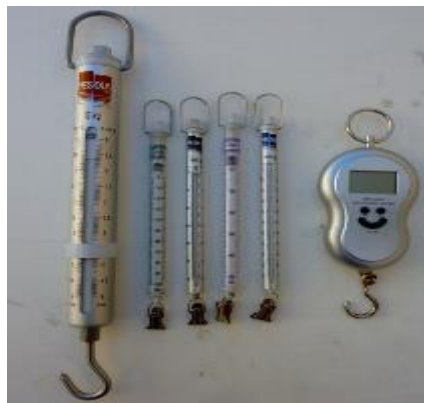
Figure 11 : Différents types de pesons utilisés lors des mesures biométriques de terrain.
