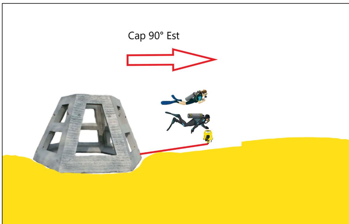
Figure 8 Déplacement des plongeurs selon une orientation choisie jusqu'à 20m de distance du récif.
